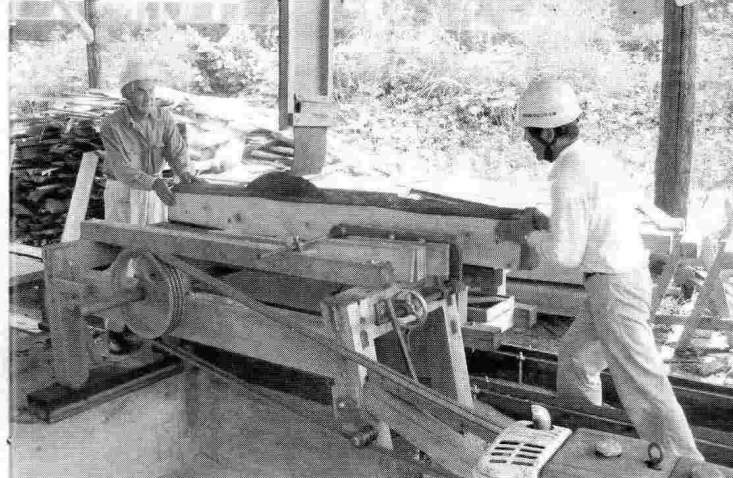
ホッキー間伐材加工研究クラブが作った製材機。材を挽いているのは、同クラブ会長・長谷田隆敏さん(左)、代表・山崎周作さん(右)
