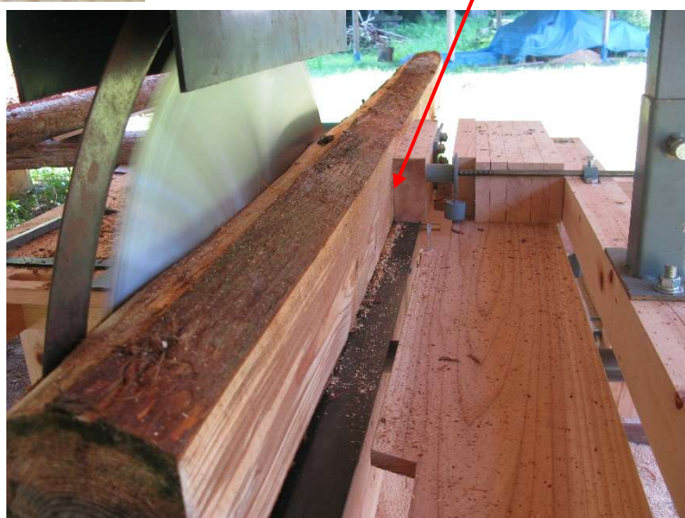
※前取り側から見た写真 前取り側定規板と挽き材との隙間
